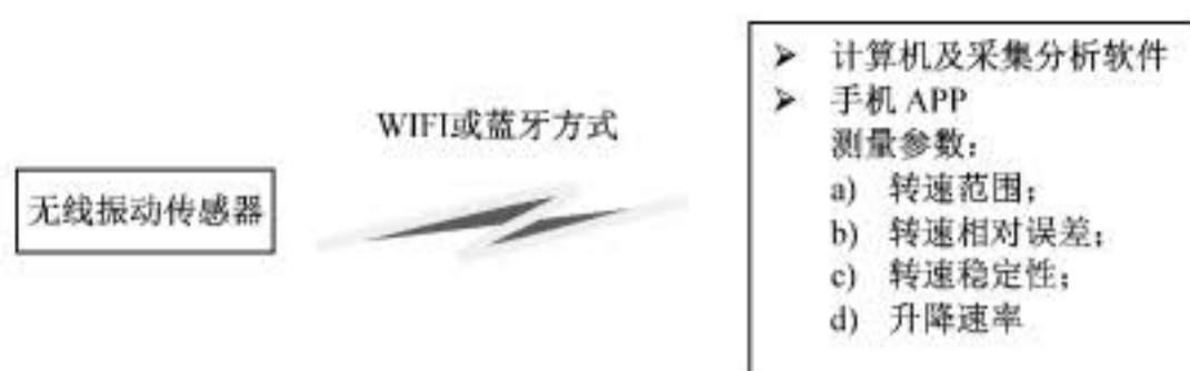
图 C.2 无线振动法测量转速方案
